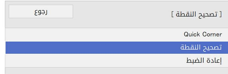
للضبط ضبطاً دقيقاً، حدد **Quick Corner** لتصحيح شكل صورة وحجمها بشكل تقريبي ثم حدد تصحيح النقطة لضبطهما بشكل دقيق.
